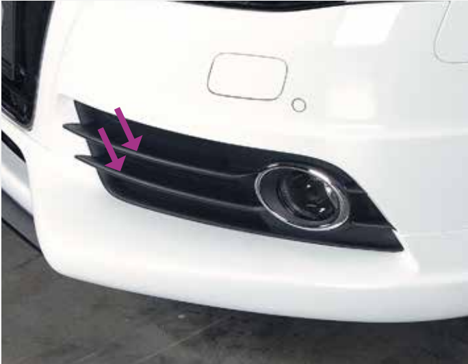
S-Line hat zwei Stege in der Nebelscheinwerferabdeckung.
