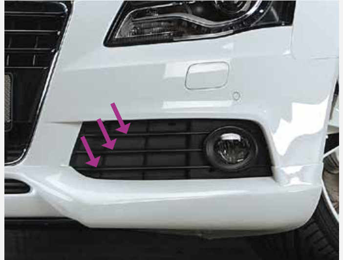
Die Abdeckung der Nebelscheinwerfer bei Nicht S-Line hat drei Stege.
